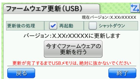
[今すぐファームウェアの更新を行う] ボタンを押すと、ファームウェアの更新が実行されます。ファームウェアの更新が開始されると、更新中のメッセージが表示されます。メッセージが表示されている間は、本製品の操作はできません。また、電源ボタンを押しても反応しません。更新に成功すると指定した設定により再起動/シャットダウンが行われます。更新に失敗するとエラーメッセージが表示されます。
