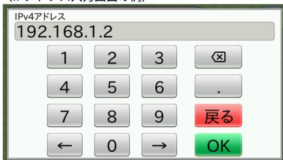
入力後 [OK] ボタンを押すと、それぞれの設定画面に戻ります。IPアドレス設定の画面にある [設定] ボタンを押すと、無線LANモジュール設定のすべての設定が反映されます。
