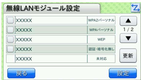
無線LANアクセスポイントが検出され、リストが表示されます。検出された無線LANアクセスポイントが1画面に収まらない場合は、[▲] ボタンと [▼] ボタンで画面を切り替えられます。
