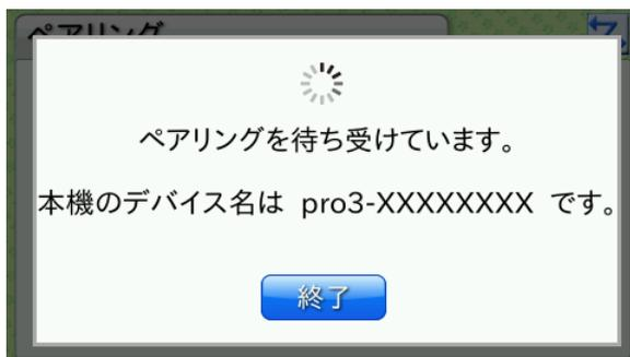
専用スマートフォンアプリから接続を行うと6桁のPINコードが表示されます。このPINコードをスマートフォン側に入力するとペアリングが完了します。
