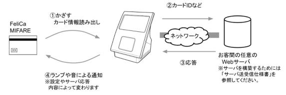
本製品が非接触IC(FeliCaカードまたはMIFAREカード)を検出してカードIDやカード情報を読み出すと、あらかじめ設定したサーバに対して、そのカードIDなどの情報をHTTP通信またはHTTPS通信で送信します。サーバは通知された情報をもとに返答を作成し、応答します。本製品はその応答によって、メッセージの表示や音声の再生を行います。
