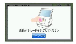
登録する非接触ICを本製品の非接触IC 読み取り部の中心に当て、ランプの点滅パターンが変わるまでかざし続けてください。非接触IC を検出すると音が鳴り、登録が完了した旨の画面が表示されます。
