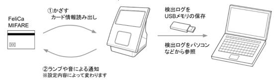
設定によって、サーバを利用しないオフラインモードを利用することができます。非接触ICを検出してカードID やカード情報を読み出し、本製品の設定に従って音声の再生を行います。
