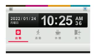
カードをかざすと、現在選択中のステータス(上図では[出勤]が選択中)で打刻することができます。各ス テータスボタンを押すと、選択中のステータスを変更できます。
