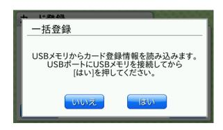
USBメモリから本製品にカード登録情報を読み込む場合は、ルートフォルダにカード登録情報ファイル(ファイル名「cardinfo.csv」)を保存したUSBメモリをUSBポートに接続し、[はい]ボタンを押します。ファイルが正しければ、次の確認画面が表示されます。
